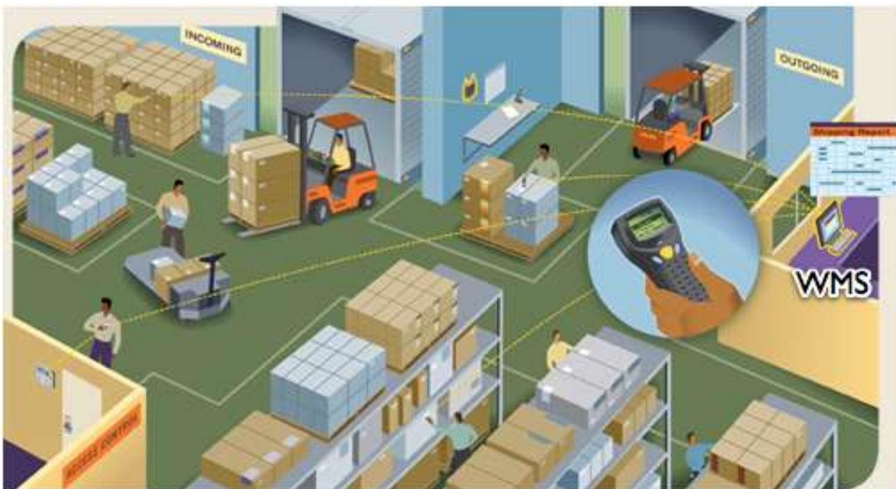
Dieses Verfahren sorgt dafür, dass die Aktivitäten von Fahrzeugen und Fußgängern (w/m/d) im Lager in Echtzeit und mit bedarfsgerechter hoher Genauigkeit (< 40cm) „getrackt“ werden können. Ein entsprechend intelligentes WMS ermöglicht in Verbindung mit dieser Technologie eine orts- und situationsbezogene Echtzeit-Prozessführung in ganz neuer Qualität.
